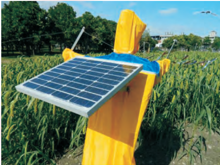
太陽能人型驅鳥器設置於小米田進行驅鳥情形
