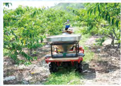
搬運車附掛施肥撒布裝置田間作業情形
