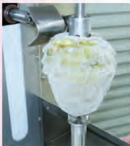
冷凍鳳梨釋迦於削皮機上削皮之情形
