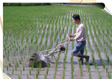
水田中耕除草機田間作業情形
