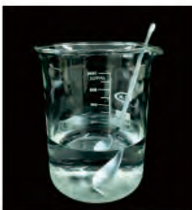
圖2. 先加入亞磷酸，攪拌至透明澄清。
