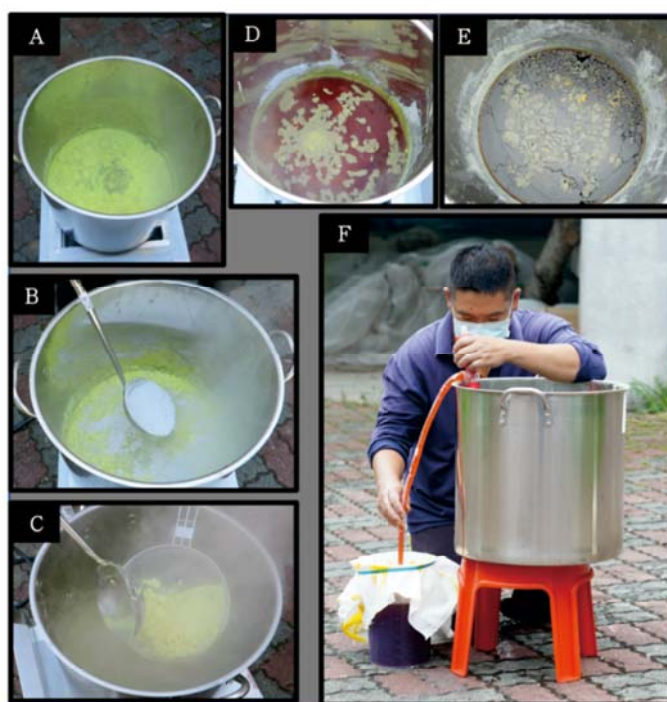
圖2.熬製石灰硫磺合劑之步驟。A:沸騰後加入硫磺，B:分次加入生石灰，C:有結塊情形需撈起壓碎，D:顏色呈現深褐色表示熬製成功，E:冷卻靜置隔夜，F:抽取上清液過濾後稀釋使用。
